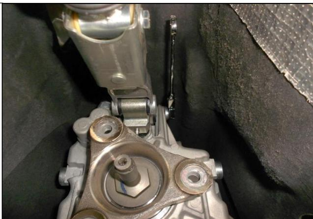
21. Remove the shift linkage bolt.
