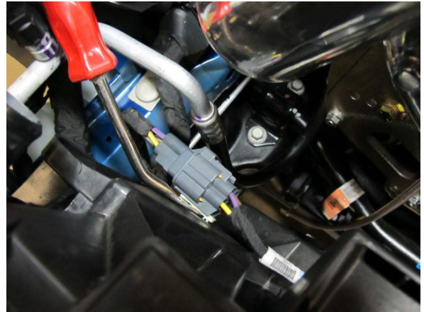
Fig. 4-m: Detach Cooling Fan Connector From Fan Shroud
