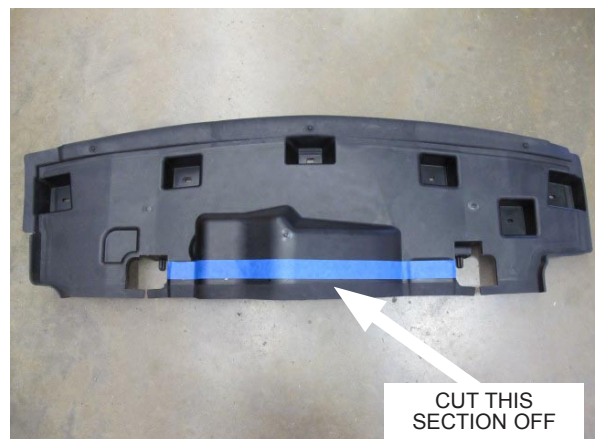
Fig. 4-aj: Modify Upper Radiator Shroud
