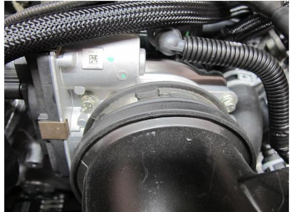
Fig. 1-m: Loosen Hose Clamp
